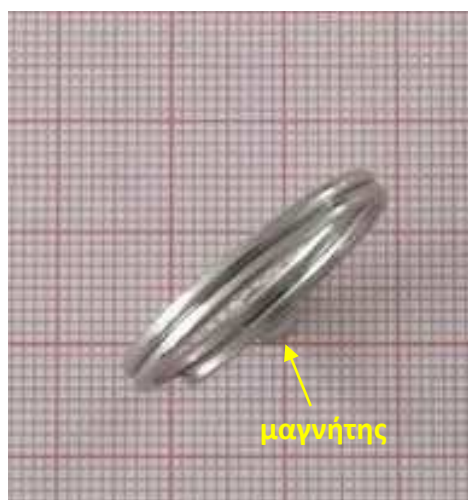
Εικόνα 2: Μαγνητική στερέωση των μεταλλικών κρίκων
