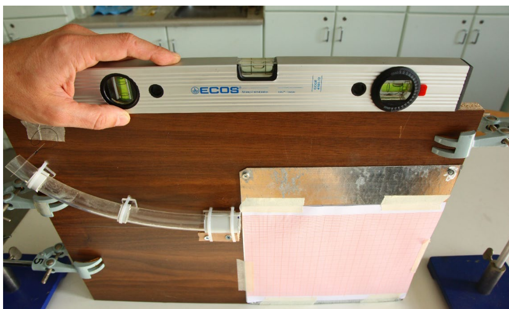
Εικόνα 4: Οριζοντίωση της διάταξης
