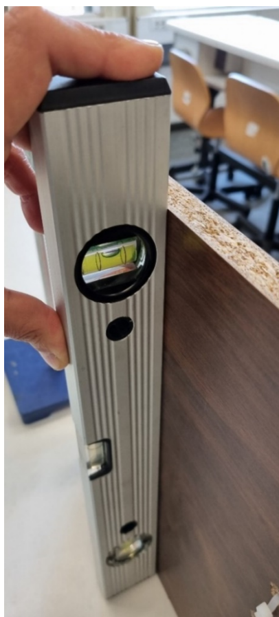
Εικόνα 5: Κατακορύφωση της επιφάνειας της διάταξης. Το αλφάδι τοποθετείται στην πίσω πλευρά της διάταξης
